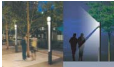
〈그림 4-22〉 보행자가 많은 일반시간대 (18~24시)에는 보행에 적당한 조도를 확보하고 안전성이 높은 배광으로 함
